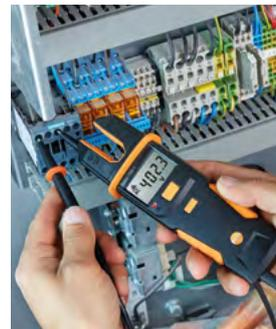
Strommessung an einer Kälte-Außeneinheit mit **testo 755**.
