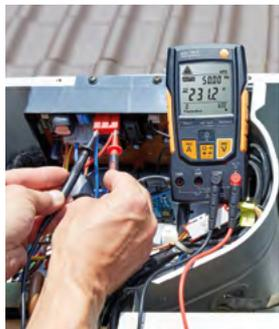
Spannungsmessung an einer Kälte-Außeneinheit mit **testo 760**.
