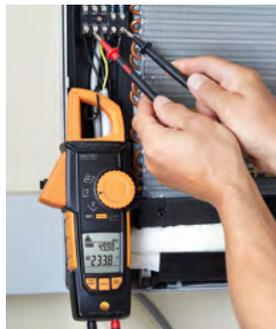
Spannungsmessung an einem Klimagerät mit **testo 770**.
