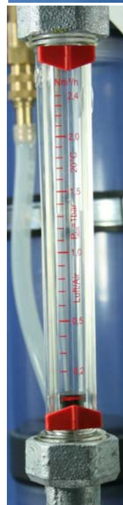
Durchflussmesser mit Ventil
