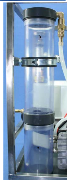
Trockenturm: A: Kondensatabscheider B: Silikagelfüllung
